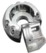
Blasform mit konturnahen Hohlräumen aus LaserForm-Maraging-Stahl (B)
