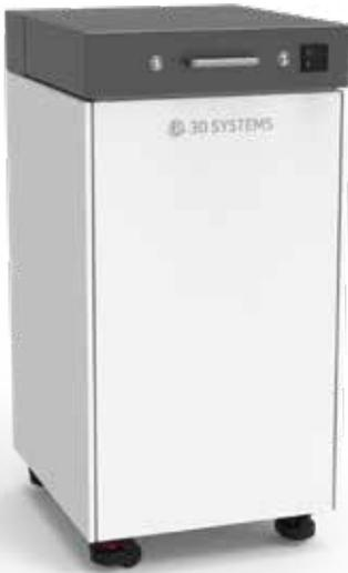
Aufgrund ihrer Ausstattung mit 16 UV-Lampen, die über die vier Innenwände verteilt sind, ermöglicht die Figure 4 UV-Aushärtungseinheit 350 eine äußerst effiziente und einheitliche Aushärtung. Die innere Konstruktion erlaubt ein Härten direkt auf der Bauplattform, oder die Teile können in mehreren Regalen platziert und gleichzeitig gehärtet werden. Die Einheit wurde für Figure 4-Modulteile mit einer Höhe von bis zu 346 mm ausgelegt.
