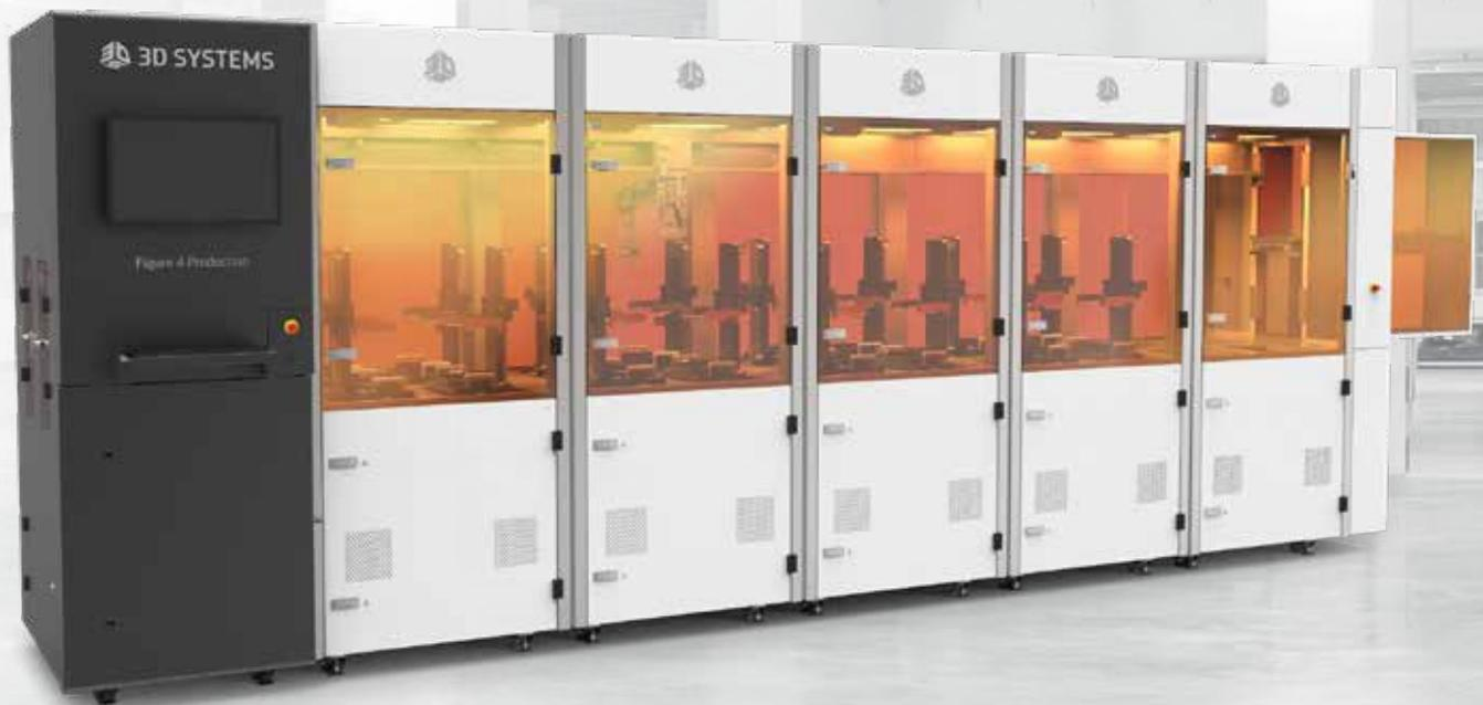
Der Figure 4 Production kombiniert die Designflexibilität der additiven Fertigung in konfigurierbaren Inline-Produktionszellen und schafft so eine anpassbare, automatisierte Lösung für die 3D-Direktfertigung.
