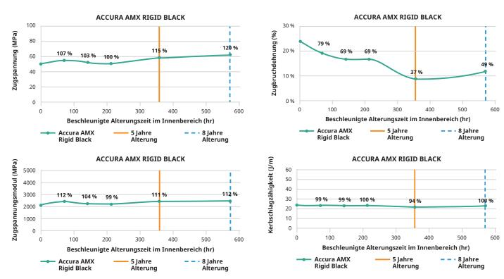
AUSSENRAUMBESTÄNDIGKEIT: Getestet nach der Standardmethode ASTM G154.
