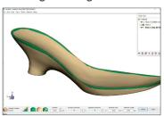
Designprozesse mit Kurven sind jetzt schneller und effizienter dank neuer Tools wie "Extract Contour Curve", "Offset Curve" und dem erweiterten Befehl "Pattern Axis Marker". Mit den neuen Arbeitsabläufen können Oberflächen schneller erstellt und Muster präziser entworfen werden.
