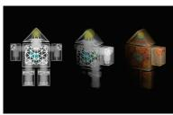
Verbesserte Genauigkeit und weniger Designiterationen durch Überprüfung der Innnenstruktur mit der neuen MultiVox-Ansicht, die die Modelltransparenz nach Schichten steuert und eine abschnittsübergreifende Analyse ermöglicht. Bevor Modelle zum 3D-Druck übermittelt werden, können Designer die inneren Abstände überprüfen und einfache Messungen durchführen, um die Passform beim Zusammenbau zu gewährleisten.
